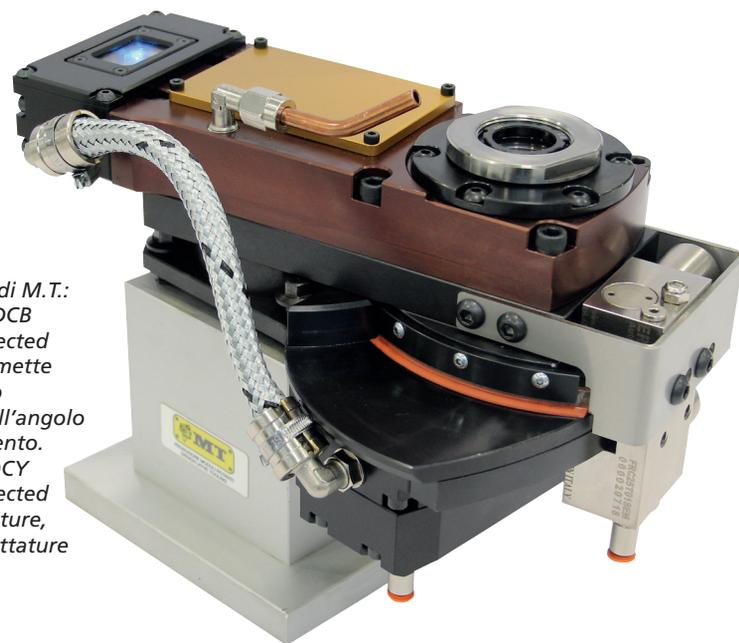
tere alla macchina in tempo reale alcuni parametri di lavorazione quali la forza assiale applicata, le vibrazioni e la temperatura, che possono essere utilizzate per realizzare un avanzato sistema di monitoraggio della lavorazione, molto sensibile poiché posto direttamente sull'utensile rotante e in grado di rilevare variazioni anche di piccola entità.
